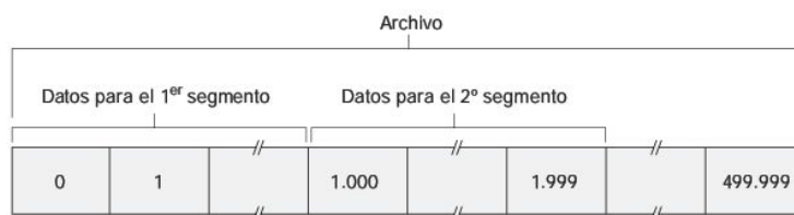
Figura 3.30 • División de los datos del archivo en segmentos TCP.
