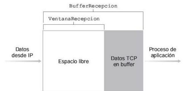
Figura 3.38 • La ventana de recepción y el buffer de recepción ( BufferRecepcion ).
